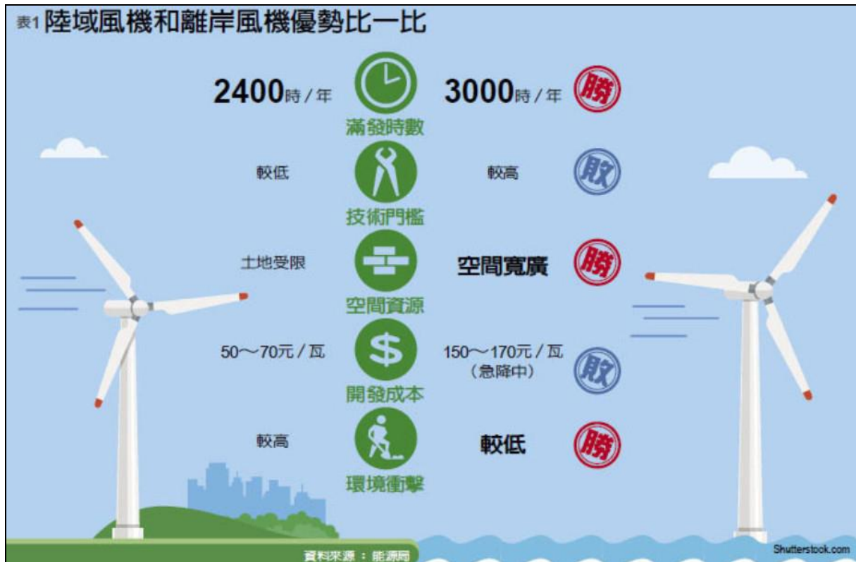
圖四、陸上風力發電（左）與離岸風力發電（右）之比較
